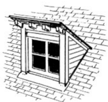
lucarne retroussée , ou demoiselle ; c'est aussi le vrai chien-assis (Source : DICOBAT)
